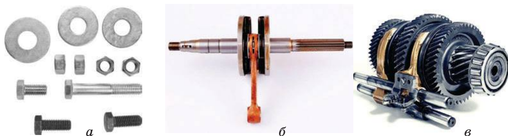
Рис. 121. Типовые (а) и специальные (б, в) детали
